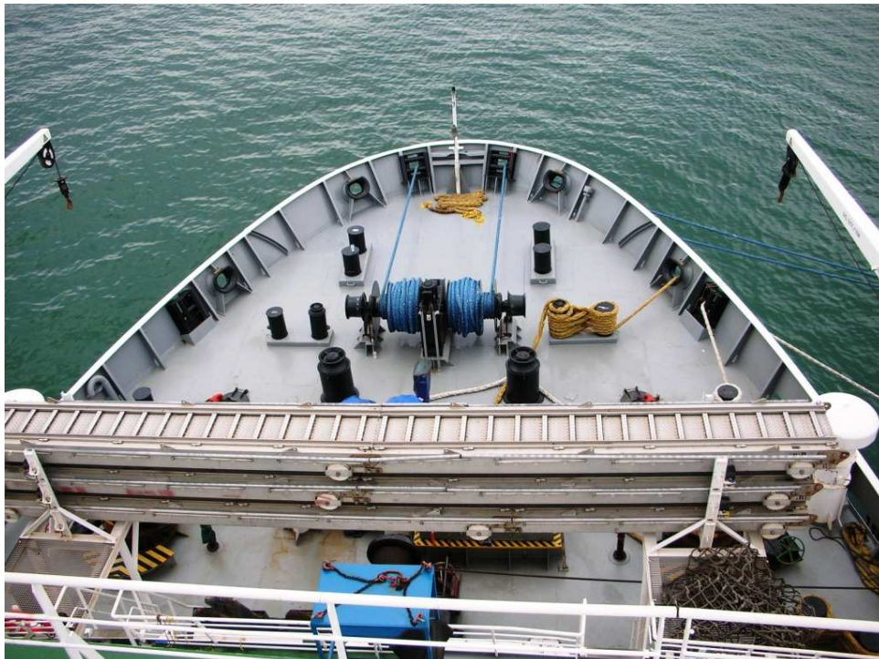
Die neue Seilwinde am Vorderdeck
