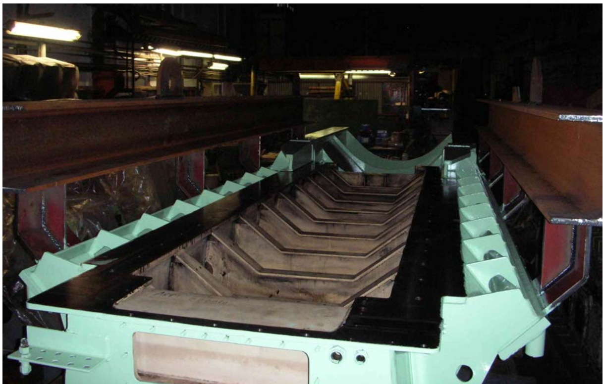
DIE NEU ÜBERARBEITETE UND GESTRICHENE ÖLWANNE DES GENERATORS (CA. 7M LANG UND 5000KG SCHWER)
